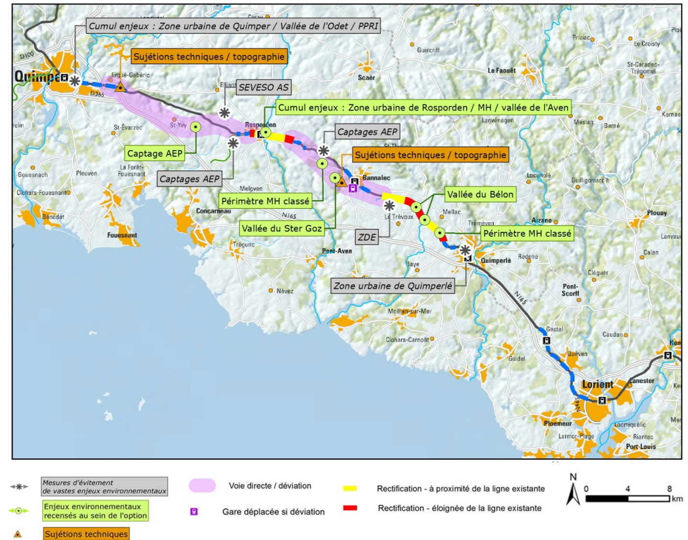
Figure 66 : Aménagements et option de passage entre Lorient et Quimper (source : INGEROP)
